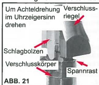
3. Entfernen Sie den Schlagbolzen aus dem Verschluss, indem Sie den Steckriegel nach außen ziehen.
