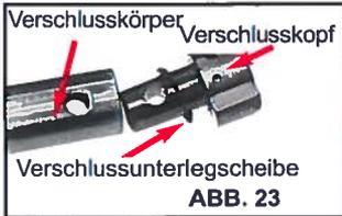
2. Drücken Sie den Verschlusskopf in den Verschlusskörper. Richten Sie den Kammerstengel von vorn gesehen in einem Winkel von 180 Grad zum Auswerfer aus. Ordnen Sie den Stift des Verschlusskopfes und die Bohrungen des Verschlusskörpers wie in Abbildung 24 an.
