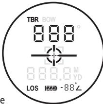
Für Gewehrscützen besteht der TBR-Modus aus drei Funktionen: Hold, MOA und BAS. Es muss einer dieser Modi ausgewählt werden. Um die gewünschte Funktion zu wählen, aktivieren Sie TBR, gehen dann das Menü durch (indem Sie die MODE-Taste drücken), über die Funktionen BOW und Kompass hinaus, bis die gewünschte TBR-Funktion blinkt. Aktivieren Sie diese Funktion durch Drücken der POWER-Taste.
