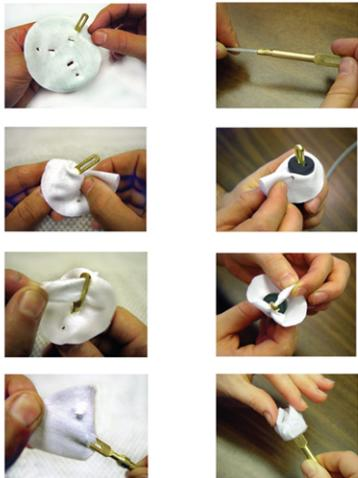
1. Befestigen Sie den passenden Patch Halter am Ende des Kabels. Beachten Sie, dass der Flinten-Aufsatz ein Innengewinde hat, der Halter geht über das Ende des Kabels.
