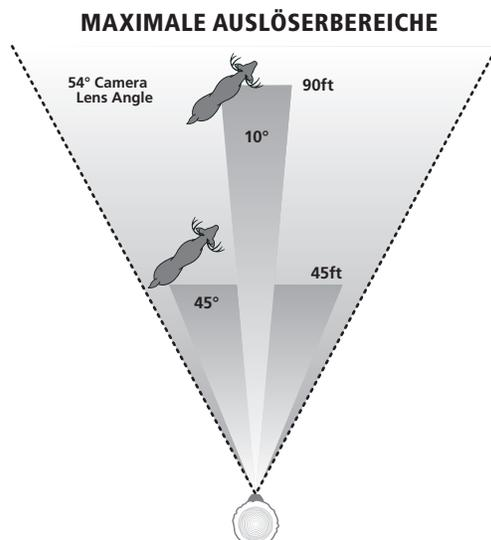
Dual Sensor Technologie (DST™) liefert ein vollständigeres Bild von der Aktivität, die sich in Ihrem Bereich abspielt. Wählen Sie den weiteren 45° Sensor vom „Custom Menu“ mit einem Bereich von 45 Fuß (ideal für größere Bereiche) oder wählen Sie den engeren 10° Sensor mit einem Bereich von 90 Fuß (Anwendung bei spezifischen Wahrzeichen oder Zubringern). Beide Sensoren können gleichzeitig aktiv sein, indem man DST auswählt. Nur die RCX-2 hat diese bahnbrechende Technologie.
