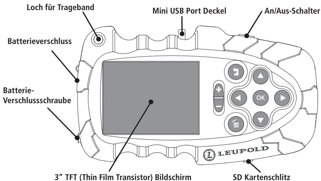
Ein Controller muss nur einmal eingestellt werden, es ist aber nötig, Datum und Zeit einzustellen und auf die Features der Kamera zu zugreifen. Jedes Mal wenn eine neue Kamera eingestellt wird, synchronisiert sich die Zeit mit dem Controller sobald sie mit dem USB Kabel verbunden wird.
