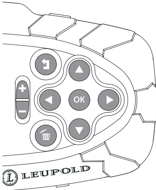
Navigieren Sie durch das Controller Menu, indem Sie die Pfeiltasten auf die gewünschte Auswahl führen.
