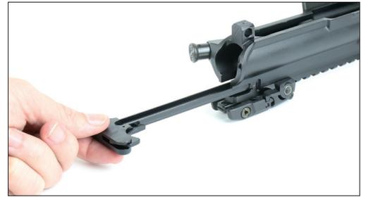
2. Den Verschluss einführen und zusammen mit dem Ladehebel nach vorne schieben bis diese einrasten.
