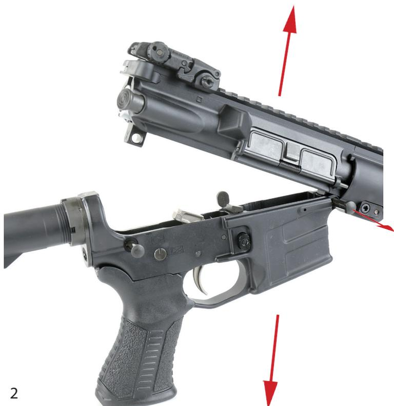
3. Den Upper drehen und den Ladehebel herausziehen. Nun kann der Verschluss aus dem Upper entnommen werden.
