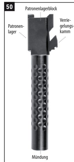
Merke: Vor dem nächsten Schießen Ihrer Waffe schieben Sie den Putzstock mit einem trockenen, sauberen Reinigungs-patch an der Putzstockspitze vom Patronenlager aus durch den Lauf, bis der Patch an der Mündung austritt. Nehmen Sie den Patch ab und ziehen Sie den Putzstock zurück. Wiederholen Sie diesen Vorgang so oft, bis kein Öl mehr am Patch zu erkennen ist.
