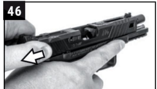
3. Fixieren Sie den Schlitten / Verschluss in seiner hintersten (geöffneten) Position, indem Sie den Verschlussfanghebel (19) nach oben drücken und den Schlitten / Verschluss langsam aus seiner hintersten Position ein kleines Stückchen nach vorne lassen, bis er vom Verschlussfanghebel gehalten wird.
