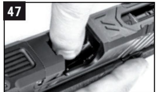
4. Wenn Sie den Schlitten / Verschluss in der hintersten Position arretiert haben, überprüfen Sie visuell und physisch (mit dem Finger) das Patronenlager, das Magazin und den Magazinschacht der Waffe, um sicher zu stellen, dass sich keine Munition mehr in der Waffe und dem Magazin befindet (Abbildung 47).
