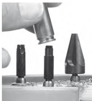
runde Vertiefung an der Kante des Gerätes. Nachdem Sie den Hülshals mit der passenden Bürste gereinigt haben, tauchen Sie ihn kurz in das Motor Mica und klopfen Sie überflüssiges Material ab. Anmerkung: dieser Arbeitsschritt sollte vor dem Ausstoßen und Kalibrieren erfolgen.
