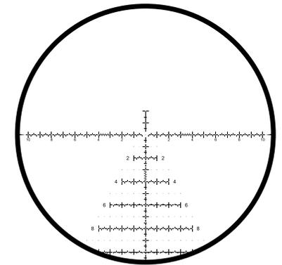
Das PR2™-Absehen wurde in Zusammenarbeit mit den besten Wettkampf- und Profischützen des Landes entwickelt und ist speziell für Geschwindigkeit und Präzision auf große Entfernungen ausgelegt. Das PR2™ ist entweder mit MIL- oder MOA-Absehen erhältlich und bietet dem Schützen ein sauberes, übersichtliches Bild, das eine hohe Zielgenauigkeit und trotzdem genügend Haltepunkte für die schnelle Trefferkorrektur ermöglicht.
