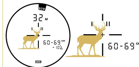
Der eingestellte Maßstab hier beträgt 60-69 cm, und der anvisierte Hirsch ist näher an der 60 cm Markierung. Die Haltemarken passen sich automatisch sofort dem gemessenen Ziel an – in diesem Fall 32 m.
