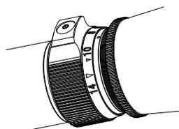
Duplex Zielpunkte mit CPC™-artigen Haltepunkten. Anpassung der Ballistik über die Vergrößerung.
